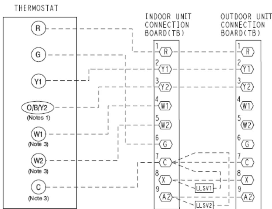
**Рис. 16 – Типовые соединения удаленного термостата – 38AUD**
