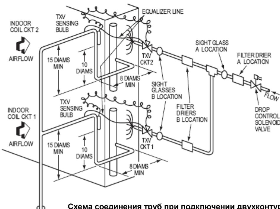
**Схема соединения труб при подключении двухконтурного теплообменника для однокомпрессорного конденсаторного блока**
