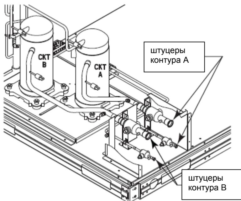
**Рисунок 5. Расположение сервисных клапанов блока 38AUD**
