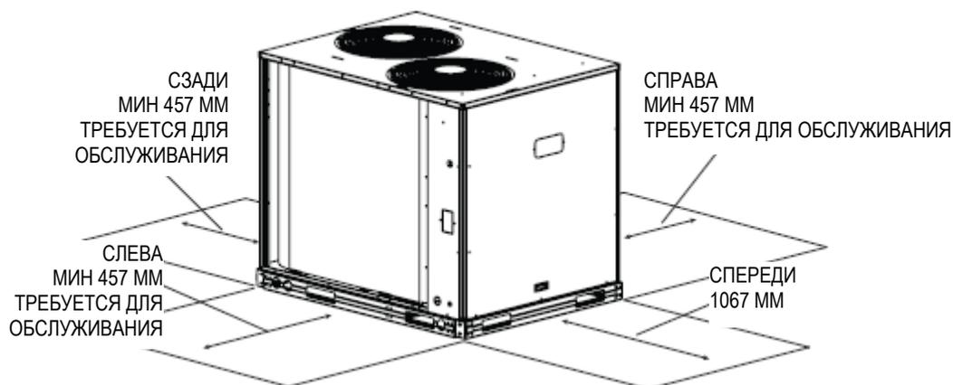
**Рис. 4 — Свободное пространство вокруг блока – размеры**
