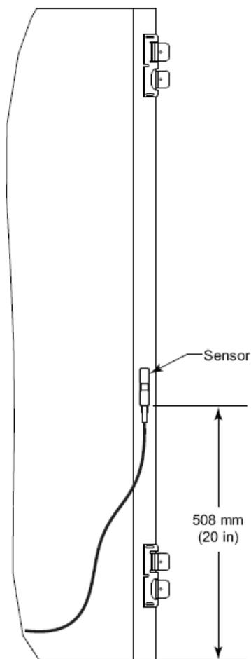
Рис. 32 – Расположение датчиков Motormaster, модель 38AUZ\*07-08
