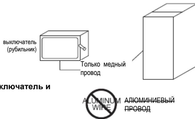
**Рис. 10 – Выключатель и блок**
