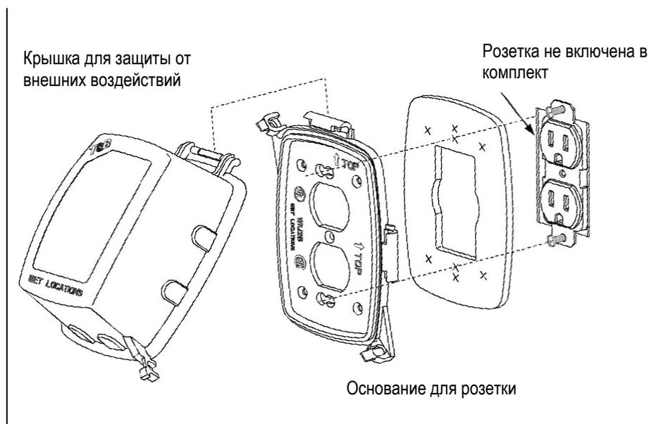
**Рис. 14 Крышка для защиты от внешних воздействий**
