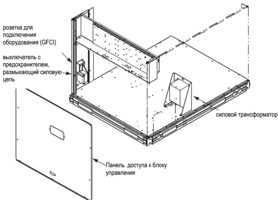
**Рис. 12 – Расположение розетки для подключения дополнительных устройств**
