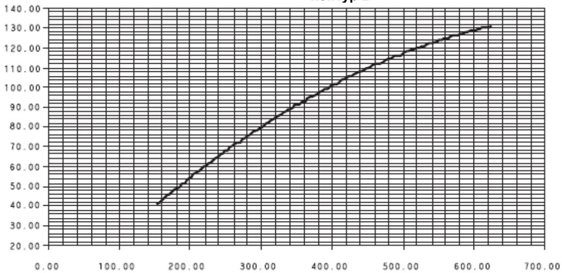
График заправки хладагента R410a при работе всех вентиляторов конденсатора
