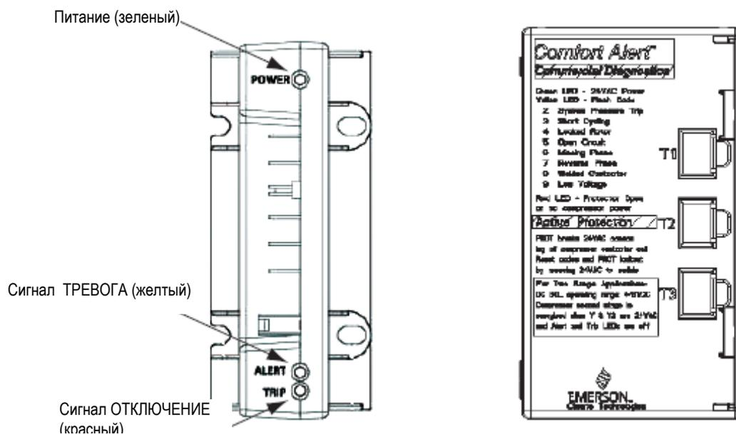
**Рис. 26 – Корпус модуля CADM / Расположение светодиодных индикаторов**
