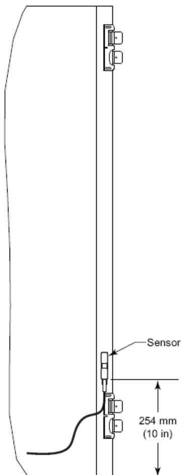
Рис. 33 – Расположение датчиков Motormaster, модель 38AUD\*12-14
