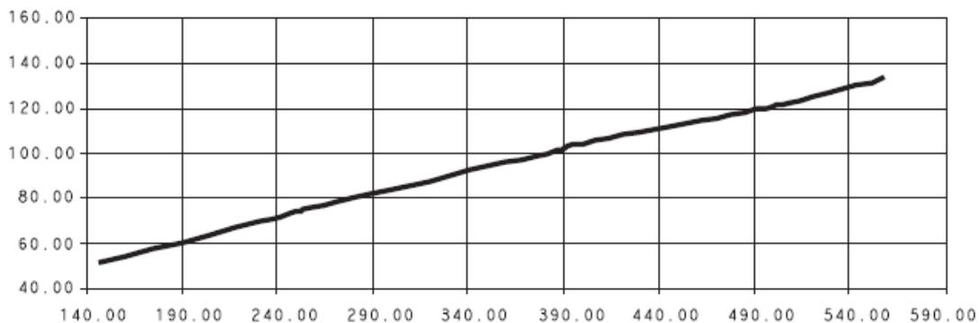
График заправки хладагента R410a при работе всех вентиляторов конденсатора
